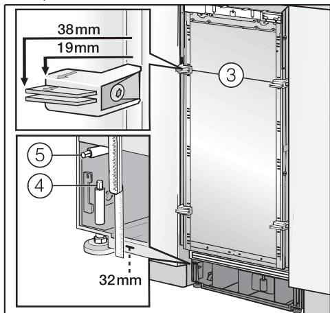
Вспомогательные элементы ③ у дверцы прибора рассчитаны на толщину мебельного фронта 19 мм или 38 мм.
