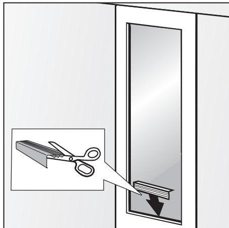
Дверные декоративные планки должны быть при необходимости укорочены до соответствующей ширины выреза в мебельном фронте. Дополнительная декоративная планка прилагается для определения требуемой длины.
