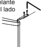
2) (Para dos puertas) Desmonte la bisagra de la mitad. Levante la puerta inferior. Vuelva a montar los tornillos de la bisagra.
