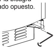
6) Ajuste de la puerta inferior: Afloje los 3 tornillos de la bisagra inferior y empuje la bisagra inferior hacia el lado deseado. Apriete los tornillos y monte la placa de base.
