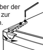
8) Handgriff umsetzen. Die Blendpfropfen für die Grifflöcher montieren.
